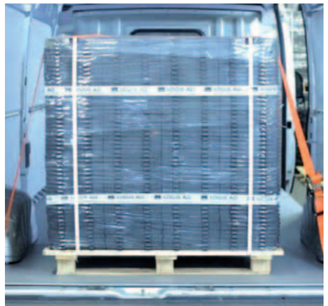
ARMs sind überflüssig, Zurrgurte nur gegen Kippsicherung
