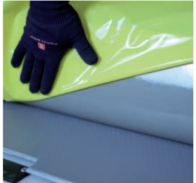
Schnelle Verarbeitung: Schutzfolie abziehen und ankleben
