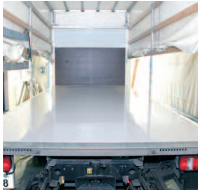
Ladeflächen lassen sich in kurzer Zeit vollflächig verkleben
